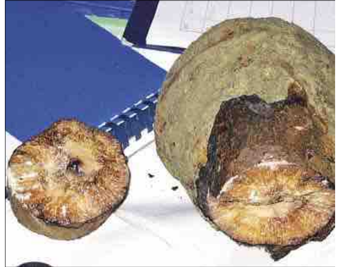
Abbildung 39: Panzerfaust mit Mischung aus TNT und Hexogen.
