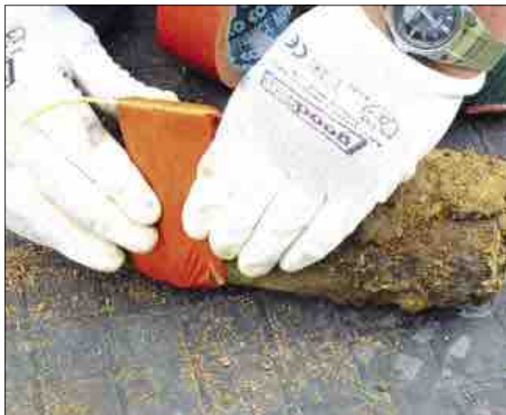
Abbildung 28: Vier Panzersprenggranaten 8,8 cm sind zur Sprengung vorbereitet. Hierzu wird eine Hohlladung verwendet, die mittels Sprengkapsel elektrisch gezündet wird. Die Zündung erfolgt gleichzeitig.
