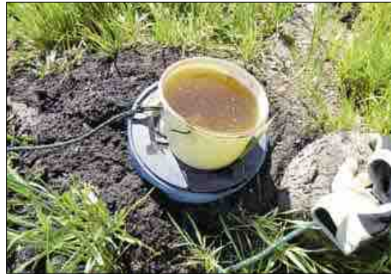
Abbildung 45: Probenahme an einem Beweissicherungsrohr mittels Membraneimer.
