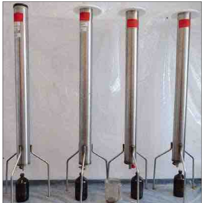
Abbildung 43: Auslaufzylinder. Sie enthalten Kompost, der mit kontaminierten Lösungen versetzt wird.
