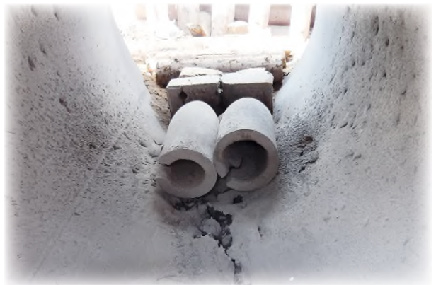
Das Schutzrohr und die beiden 28-cm-Granaten haben durch die vielen Sprengungen gelitten
