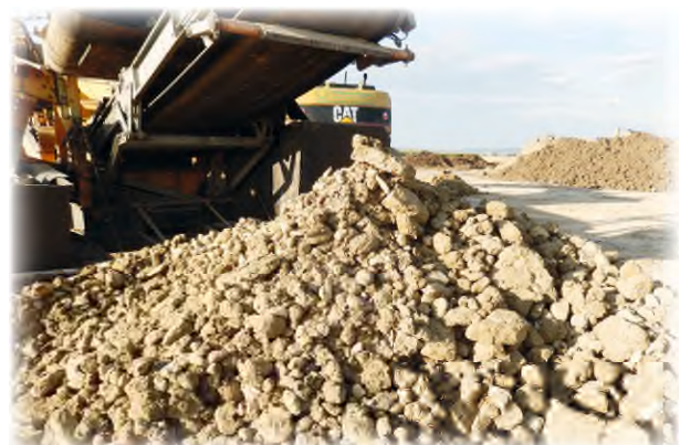
Grobfraktion der Siebanlage
